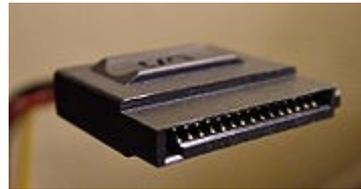
Un connecteur d'alimentation électrique SATA. Il est semblable à un connecteur de données, mais en plus large (il possède 15 broches au lieu de 7).
