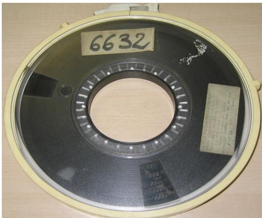
Il s'agit d'un ruban de polyester enduit de particules magnétiques (oxyde de fer).
