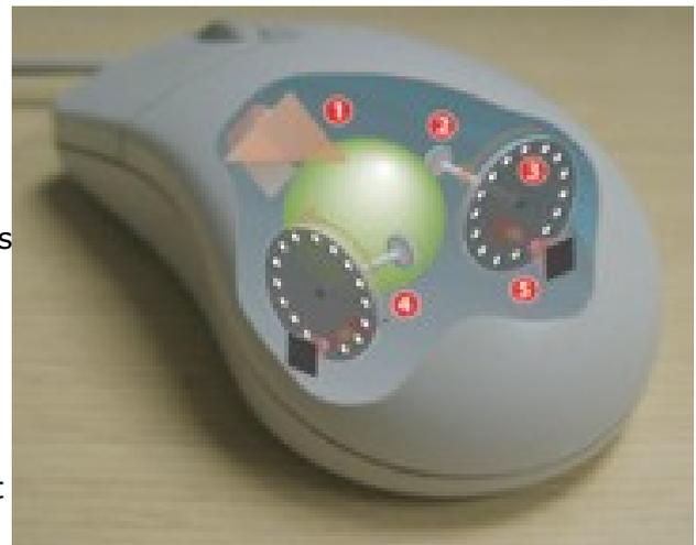
Le principal inconvénient de la souris mécanique est le dépôt de poussières qui s'accumulent sur les rouleaux, modifiant aléatoirement le transfert des mouvements de la boule aux rouleaux. En raison de ce phénomène, la plaque trouée supportant la boule dans la partie inférieure de la souris est démontable, permettant à l'utilisateur de nettoyer les rouleaux.
