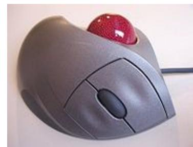
La souris informatique est une évolution technique de la boule de commande qui a tout simplement été inversée. En effet, le principe de fonctionnement de la boule de commande est exactement le même que celui de la souris à boule.
